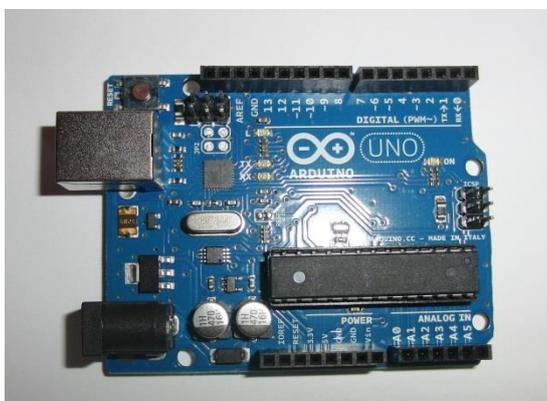
*Placa y microprocesador Arduino para ser montado en un robot.*
